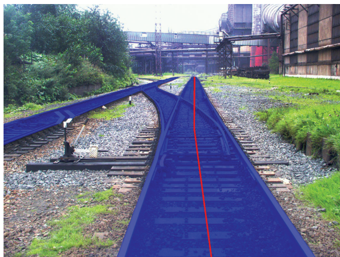
Рис. 2. Предсказание траектории движения локомотива по определенному нейронной сетью железнодорожному пути
