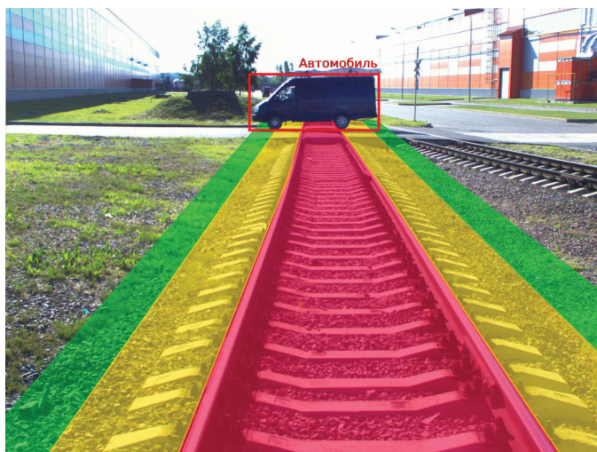
Рис. 1. Железнодорожный путь с габаритными зонами и препятствием
