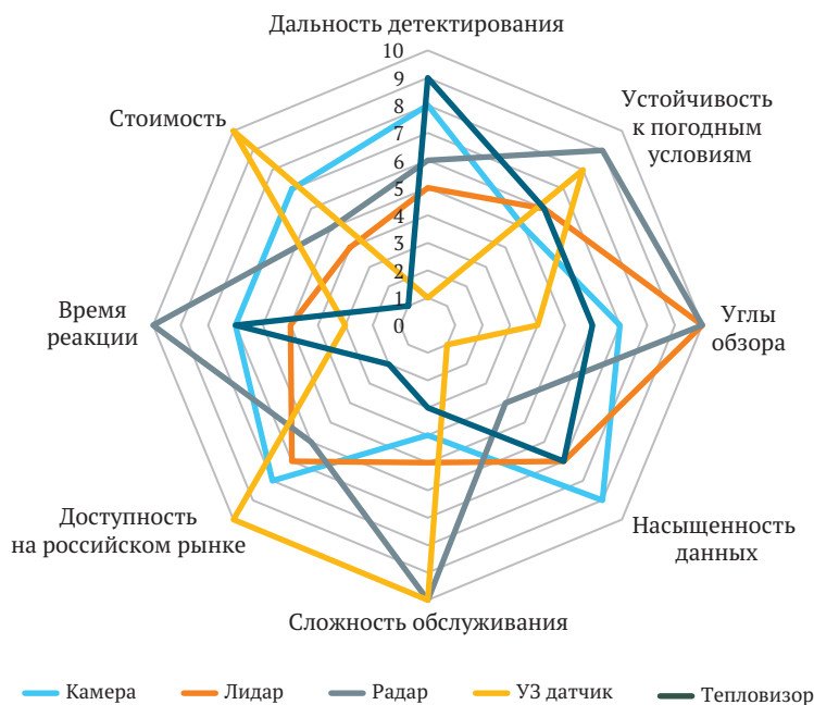
Рис. 6. Сравнение эффективности сенсоров технического зрения по ключевым параметрам на основе 10-балльной оценки специалистов ЛТС
